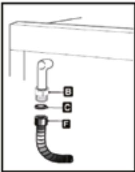
Conexión con un tubo flexible de acero (para todos los tipos de gas)
