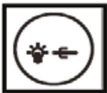
Este mando permite la función Grill / Rotisserie se active o la luz interior del horno se encienda para comprobar el progreso de la cocción de la comida.
