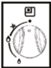
Para encender la llama, presione el pomo y girarlo hacia la izquierda hasta el símbolo de llama mínima. Para regular la llama gire el mando en la zona entre el máximo y el mínimo. Para activar el quemador, gire la perilla a la posición.
