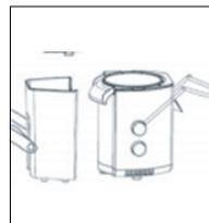
5. Coloque el depósito de pulpa en su sitio, en el lado izquierdo de la base inclinándolo suavemente debajo del recipiente de zumo.
