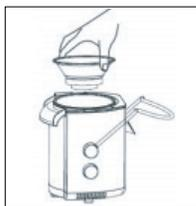
4. Coloque el filtro en el depósito de pulpa, asegurándose de que el filtro se ajusta en su sitio.
