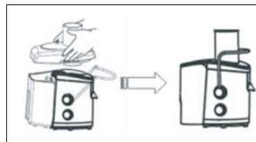
6. Coloque la cubierta sobre el recipiente de zumo y ajústela en su sitio colocando la palanca de bloqueo en los huecos de la cubierta.
