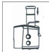
7. Deslice el empujador de alimentos dentro del tubo de entrada.
