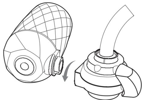
5 Inserte el conector de la base del filtro en la unidad principal y apriete verticalmente.
