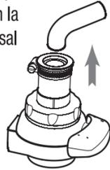
6 Si el diámetro del grifo es de 19-24 mm, por favor, retire la junta selladora de la conexión universal y proceda a instalarlo haciendo referencia al método de instalación
