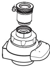
5 Por favor inserte el extremo redondo del grifo en la conexión universal y apriete el anillo de retención en la junta universal
