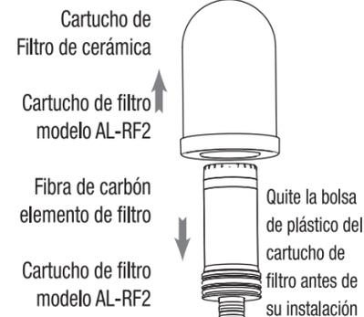
3 Inserte el cartucho de filtro / Extraiga la base y apriete la carcasa protectora del filtro
