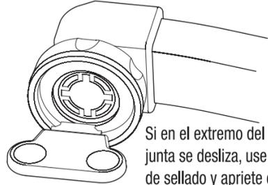
Si en el extremo del grifo la junta se desliza, use el aro de sellado y apriete con la llave
