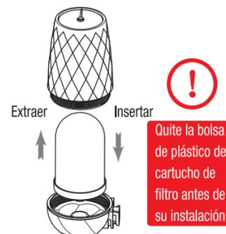
4 Haga coincidir la conexión de la base del filtro en la dirección de la flecha.
