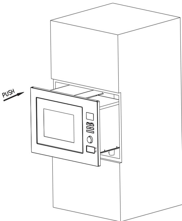
b) Empuje el horno de microondas hasta el fondo del mueble.(Fig.2)
