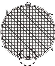
2. Presione hacia abajo todas las trabas de seguridad de la rejilla frontal con la guarda trasera
