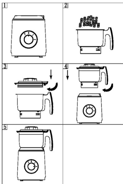
1. Coloque la unidad principal en una mesa de trabajo plana y seca, asegúrese de que la perilla del interruptor esté ajustada a "0" antes de enchufar la alimentación (consulte la figura 1) y conecte una fuente de alimentación que cumpla los requisitos de la placa de identificación de la unidad principal. (230V)
