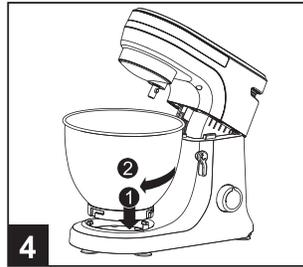
Coloque el recipiente en la base y gírelo hacia la derechas hasta que encaje.
