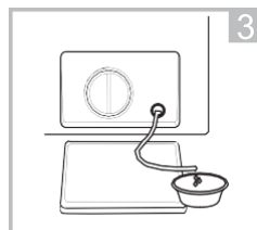
3 Después que desagote el agua Reconecte la manguera de drenaje. (La manguera de drenaje de emergencia opcional)
