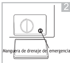
2 Girar 90° y sacar la manguera de drenaje de emergencia y retire la tapa de la manguera. (La manguera de drenaje de emergencia opcional)
