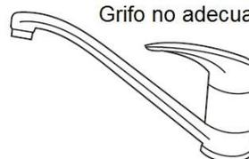
El extremo delantero debe ser mayor de 10 mm. La cara del extremo de salida del grifo debe ser plana y lisa, de no ser así debe limarla para evitar fugas.
