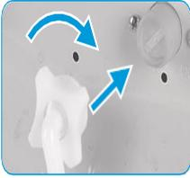
Conecte la manguera de suministro de agua a una válvula de entrada y o un Grifo de agua Fría como se indica.
