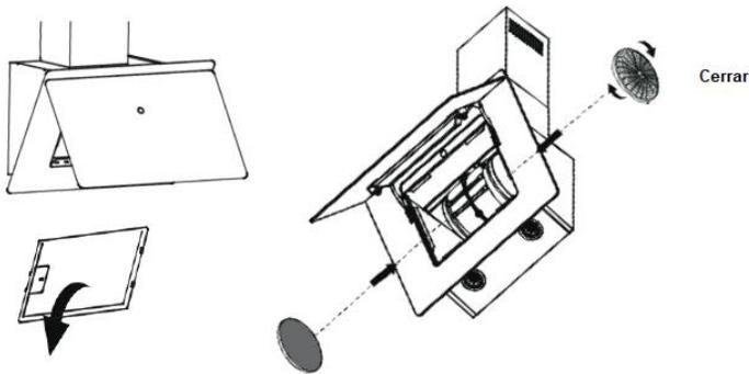
Para instalar los filtros de carbón, primero se deben quitar los filtros de aluminio presionando el bloqueo y tirando del mismo hacia abajo. La campana extractora y/o la placa de cocción inferior deben estar apagadas.
