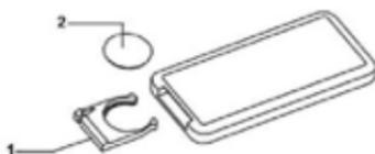
2. Coloque la batería dentro de la ranura, con el ánodo y el cátodo en las posiciones correctas.
