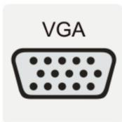
**vga**- Este es un conector analógico que conecta el monitor a la unidad del sistema.
