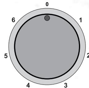
El reloj mecánico se puede utilizar para la cuenta regresiva hasta los 90 minutos. El tiempo lo puede ajustar girando el reloj a la derecha. Cuando el tiempo transcurre, se oye el signal. Si quiere romper con la cuenta regresiva antes del tiempo límite, gire el botón hasta la posición „0“.
