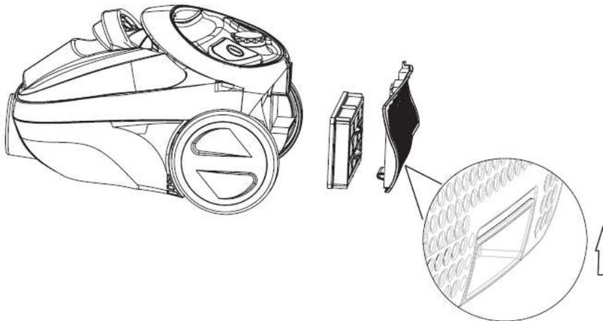
1. Empuje el pestillo de la rejilla de salida de aire hacia arriba. Retire el filtro.
