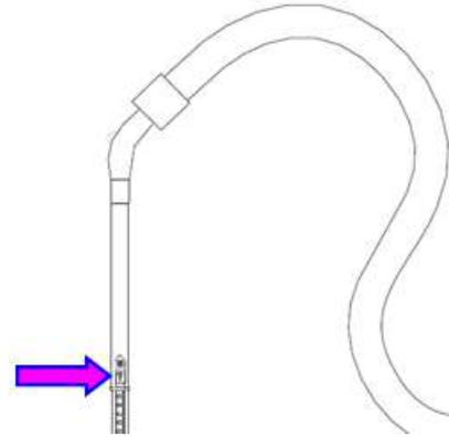
3. Conecte el accesorio de limpieza deseado al extremo del tubo.
