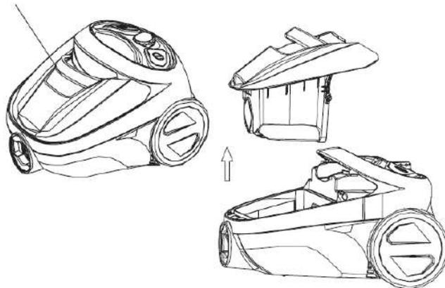
2. Tire del pestillo hacia arriba para abrir la tapa del depósito de polvo. Retire el filtro y vacíe el contenido.
