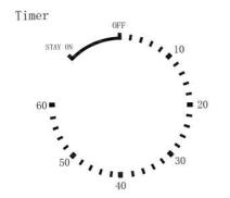
Temporizador. Utilice para seleccionar el tiempo de funcionamiento deseado. El máximo tiempo para el temporizador son 60 minutos
