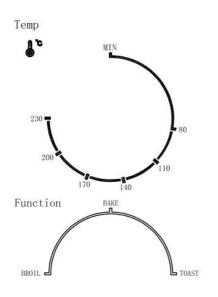
Perilla de control de temperature Ajuste esta perilla para seleccionar la temperatura. La máxima temperatura permitida son 230°C
